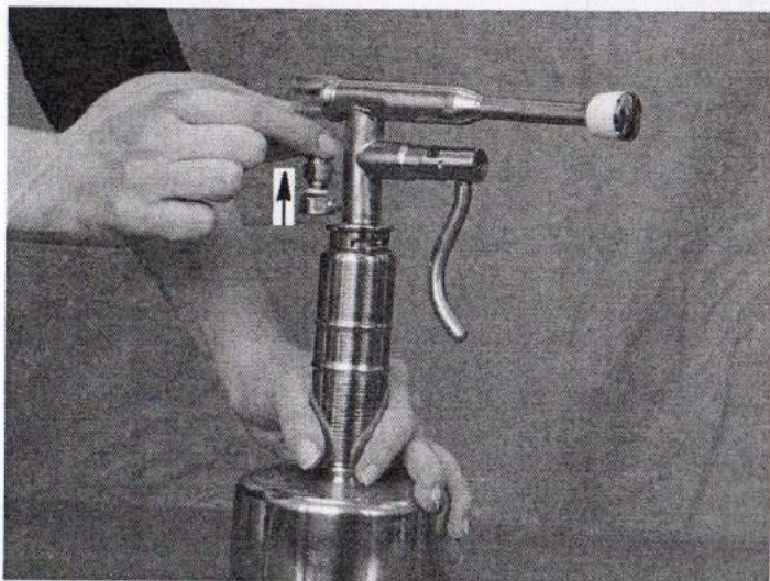
Рис.9. После окончания работы приподнять колпачок предохранительного клапана, сбросить давление в сосуде.
