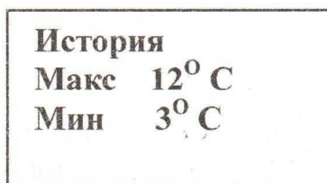
Рис. 9 –Экран температур, отображается максимальная и минимальная температуры прошлого цикла
