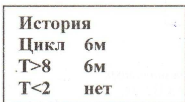
Рис. 8 –Экран времени, отображается время прошлого цикла и время нарушения
