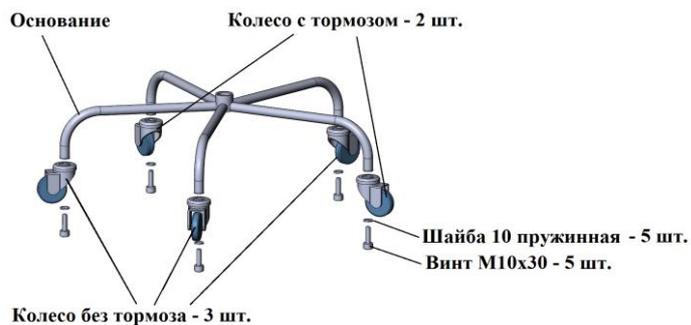
Держатель насадить на стойку с усилием исключая свободный съем его со стойки. С помощью винта M10x30 и пружинной шайбы 10 соединить стойку с основанием.
