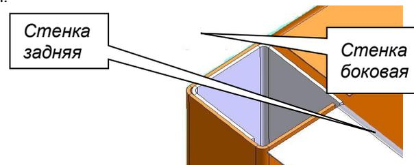
2.2.2. Соединить при помощи винтов короб средний (6) с боковыми стенками (8).
