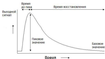
Рисунок 3. Форма изменения сигнала электрохимического датчика
