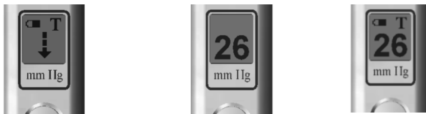
а) готовность к работе (после включения) б) режим измерения в) измерение завершено.
