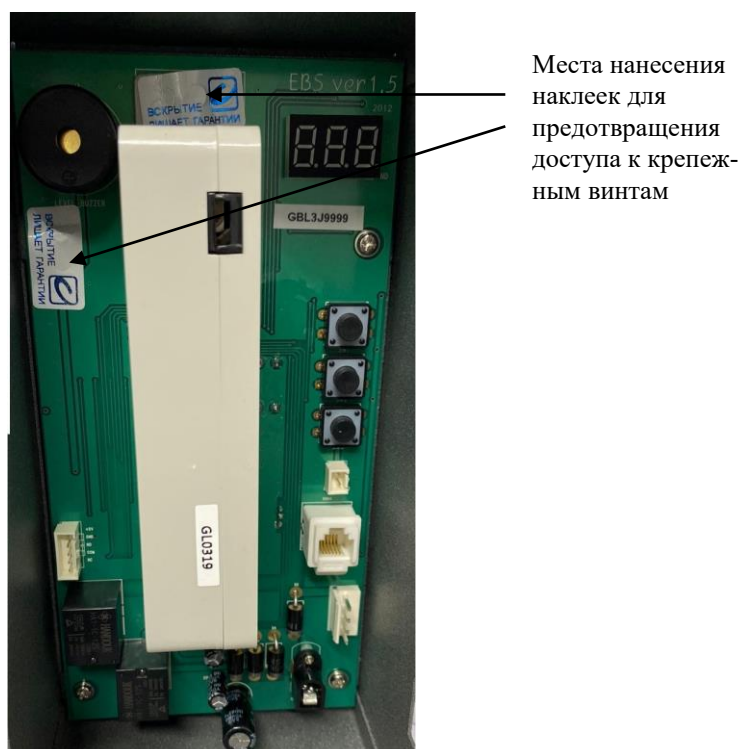
Рисунок 2. Анализатор Динго В-01, вид сзади при открытой крышке
