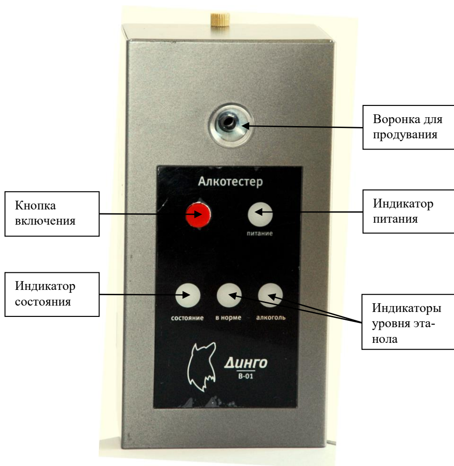
Рисунок 1. Анализатор Динго В-01, вид спереди
